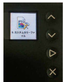
▲ スキャナー本体のカラーディスプレイの表示を確認しながら、スキャン条件を選択してスキャンの実行
